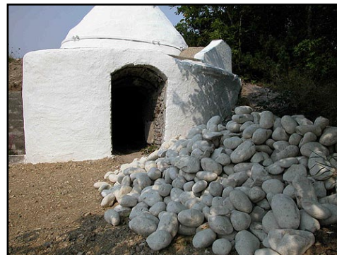
Illustr.3 Opgravede kalkrullesten klar til brænding.
